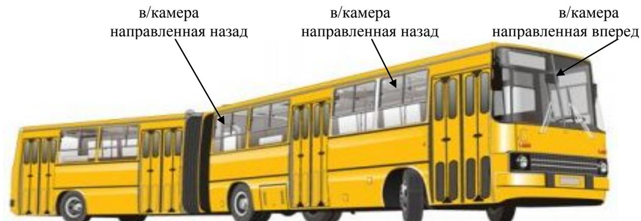
Таким образом, один прибор может решать несколько задач одновременно. Одна камера может быть установлена в кабине водителя, одна камера следить за ситуацией на дороге, третья камера вести наблюдение за салоном, а четвертая камера, например, за обстановкой вокруг автомобиля на предмет несанкционированного слива топлива из бака, а так же возможно заснять и увеличить отдельно взятый момент правонарушения или ДТП.
